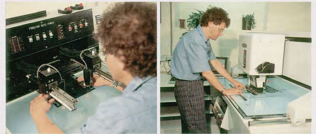
Paßgenaue Filmmontage mit dem DigiMont (Shimogaki-)Montagesystem. Hier arbeitet gerade Wolfgang Auge an der Filmstanze (links) und am System selbst (rechts).
