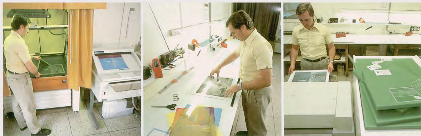
Proofherstellung mit Fuji Color Art: Rudolf Betz demonstriert die Arbeitsschritte: Belichtung der Farbfilmfolien im Kontaktkopier-rahmen und Entwicklung der Folien im Processor CA600P (linke Abbildung), Einpassen auf dem Zwischenträgermaterial (Mitte) und Erstübertragung des Bildes auf den Zwischenträger im Thermoprinter CA600T. Wenn alle vier Farbauszüge auf den Zwischenträger übertragen sind, erfolgt der Transfer auf das endgültige Trägermaterial.
